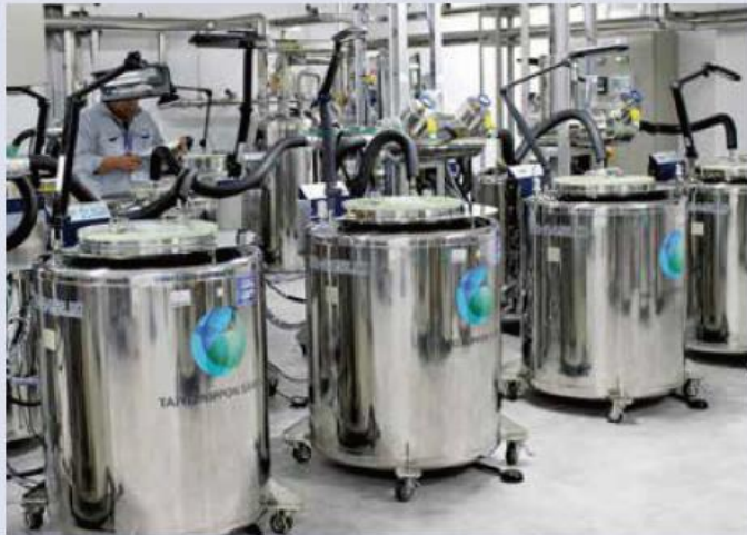
新鮮組織検体は自動供給型液体窒素タンクで保管
